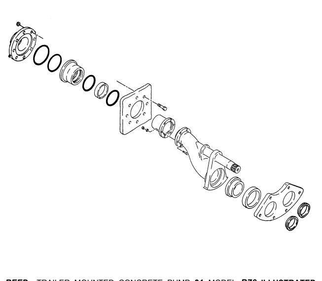
**REED** TRAILER MOUNTED CONCRETE PUMP **01** MODEL **B70** ILLUSTRATED **PARTS MANUAL GROUP 60 PUMPING TRAIN INSTALLATION** CONTAINS THE FOLLOWING FIGURES:
