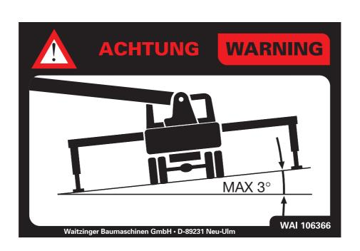
Fig. 2.31 Item 15 - WAI106366 - Max. inclination  $3^{\circ}$
