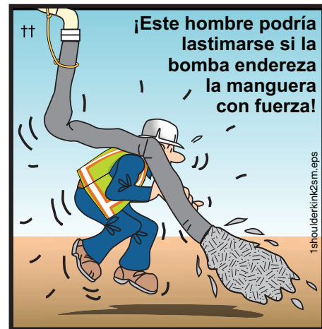
Figura 49 Doblar la manguera crea un peligro
