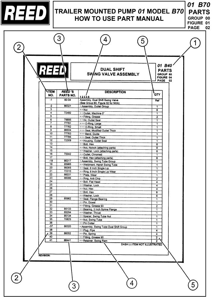
01 B70 TRAILER MOUNTED PUMP 01 MODEL B70 HOW TO USE PART MANUAL
