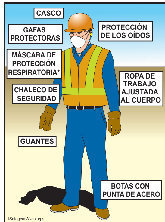
Figura 38 Use Equipo Personal de Protección (P.P.E.)
