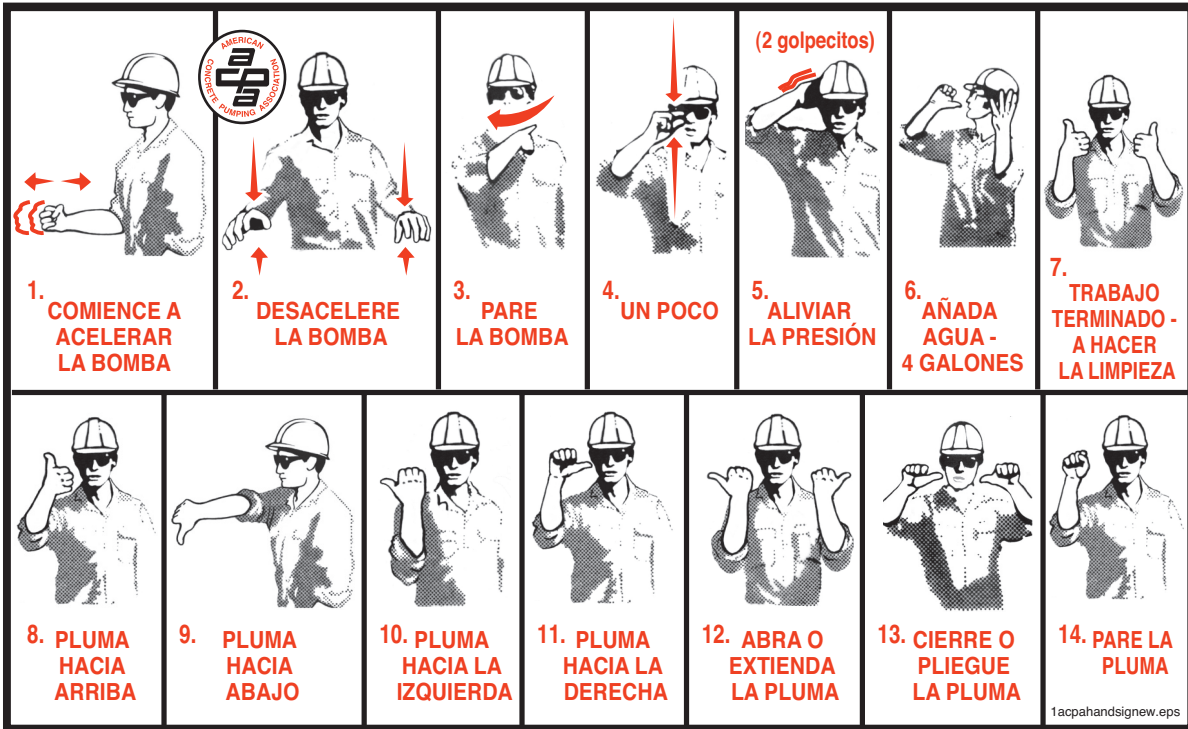
Figura 89 Señales de mano recomendadas por la ACPA (Asociación Americana de Bombeo de Concreto)
