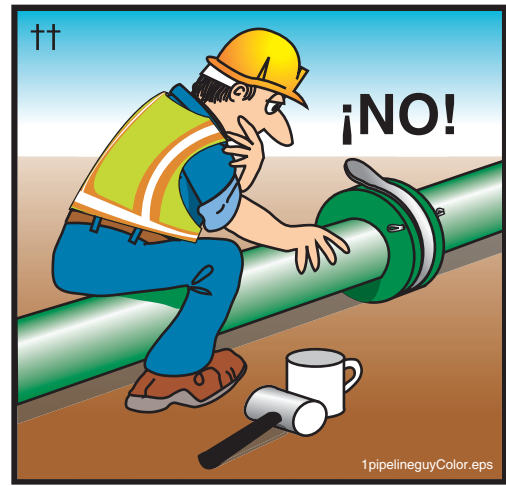
Figura 73 Nunca se ponga a horcajadas o se siente sobre una tubería presurizada
