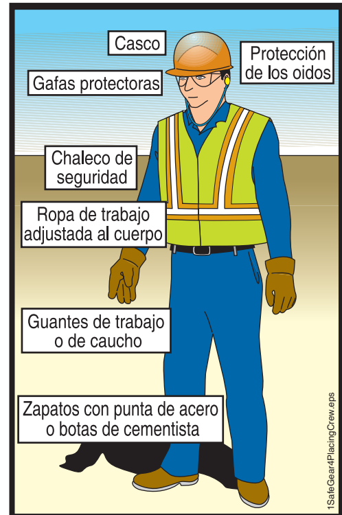
Figura 81 Use Equipo Personal de Protección (P.P.E.)
