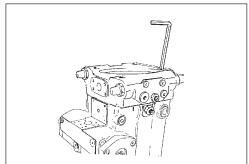
Lage der Hilfspumpe und Anschlußplatte markieren. Anschlußplattenbefestigung lösen.
